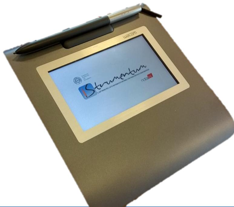
La **FIRMA GRAFONOMETRICA** è una particolare «firma elettronica», ottenuta firmando su uno specifico supporto tecnologico quale tablet o pad di firma utilizzando una penna. È una firma biometrica capace di acquisire, grazie a campionature dedicate, una serie di dati comportamentali della persona che firma.
